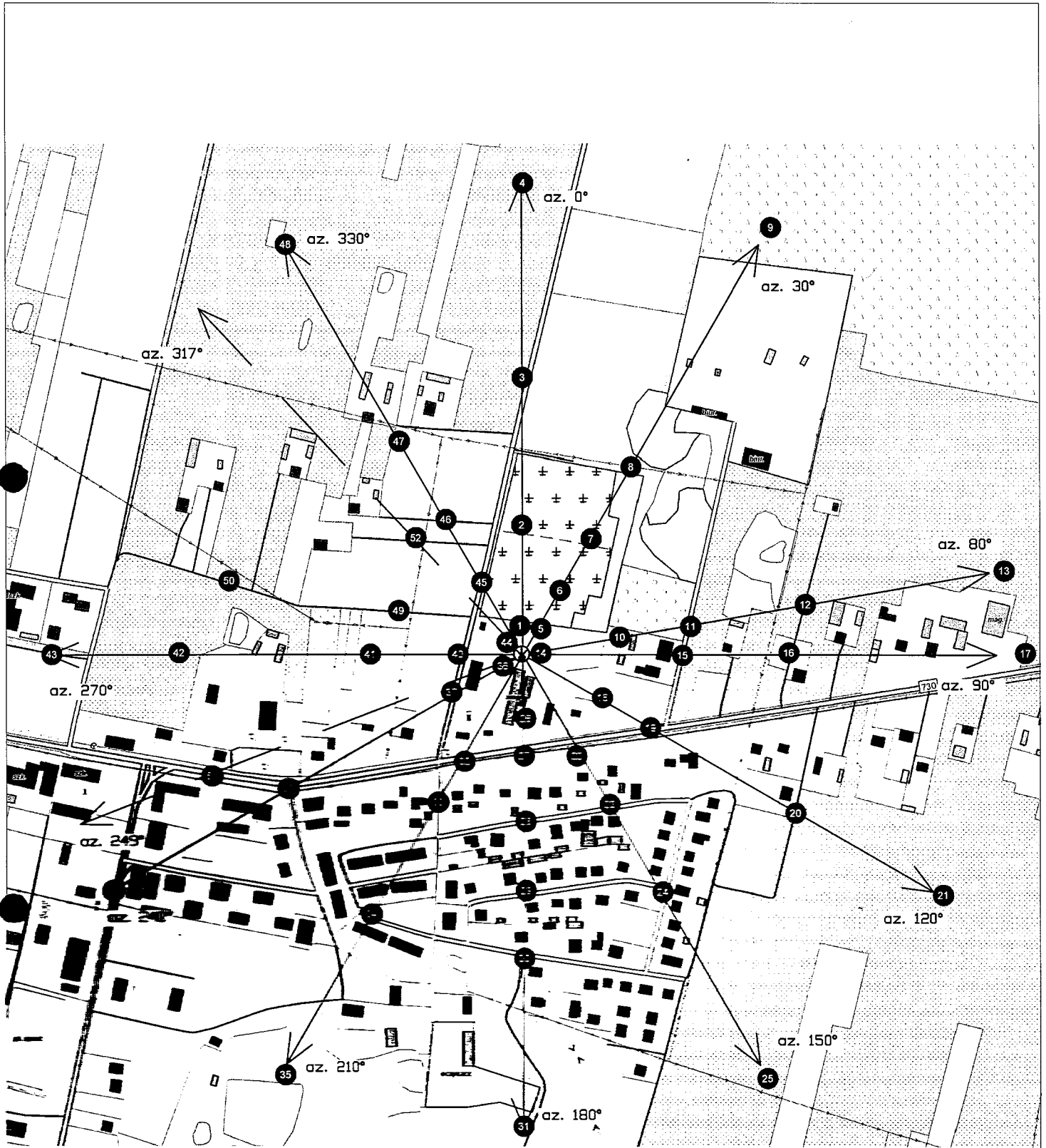
Rys.1 Lokalizacja pionów pomiarowych
